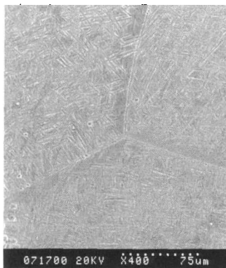
图 2 TC4 母材的显微组织
